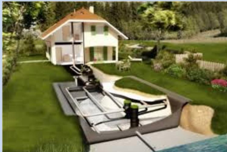
L'évacuation des eaux usées domestiques traitées est réalisée en priorité **par infiltration** dans le sol et à défaut à titre dérogatoire **par rejet vers le milieu hydraulique superficiel** (cours d'eau, fosse...).
